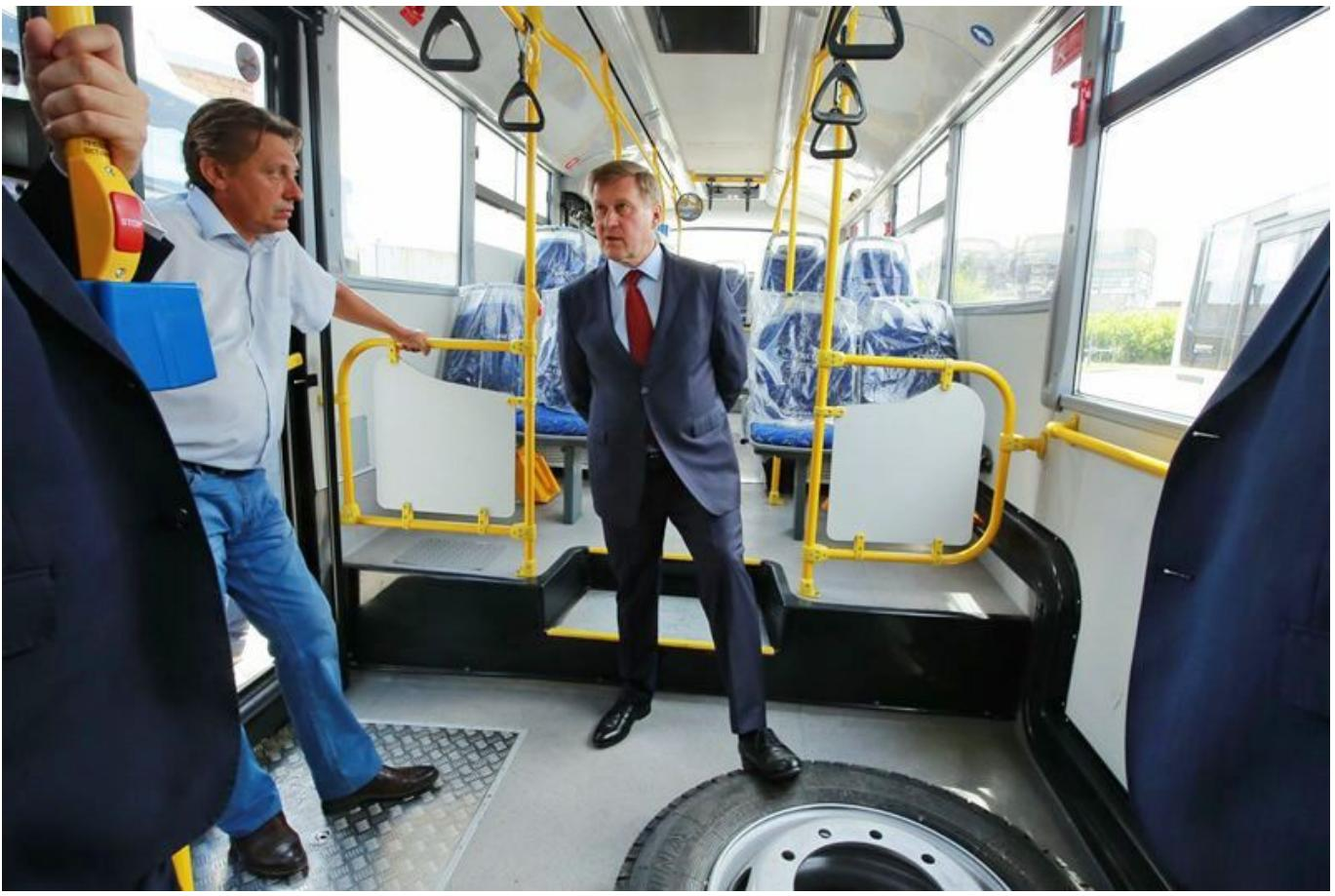
Все поступившие автобусы оборудованы двигателями, работающими на газомоторном топливе, соответствуют требованиям доступной среды, оборудованы кондиционером, системами навигации, бескондукторной оплаты проезда, видеонаблюдения. Кроме того, автобусы имеют двойное остекление салона и теплоизолирующий пол из сэндвич-панелей.
