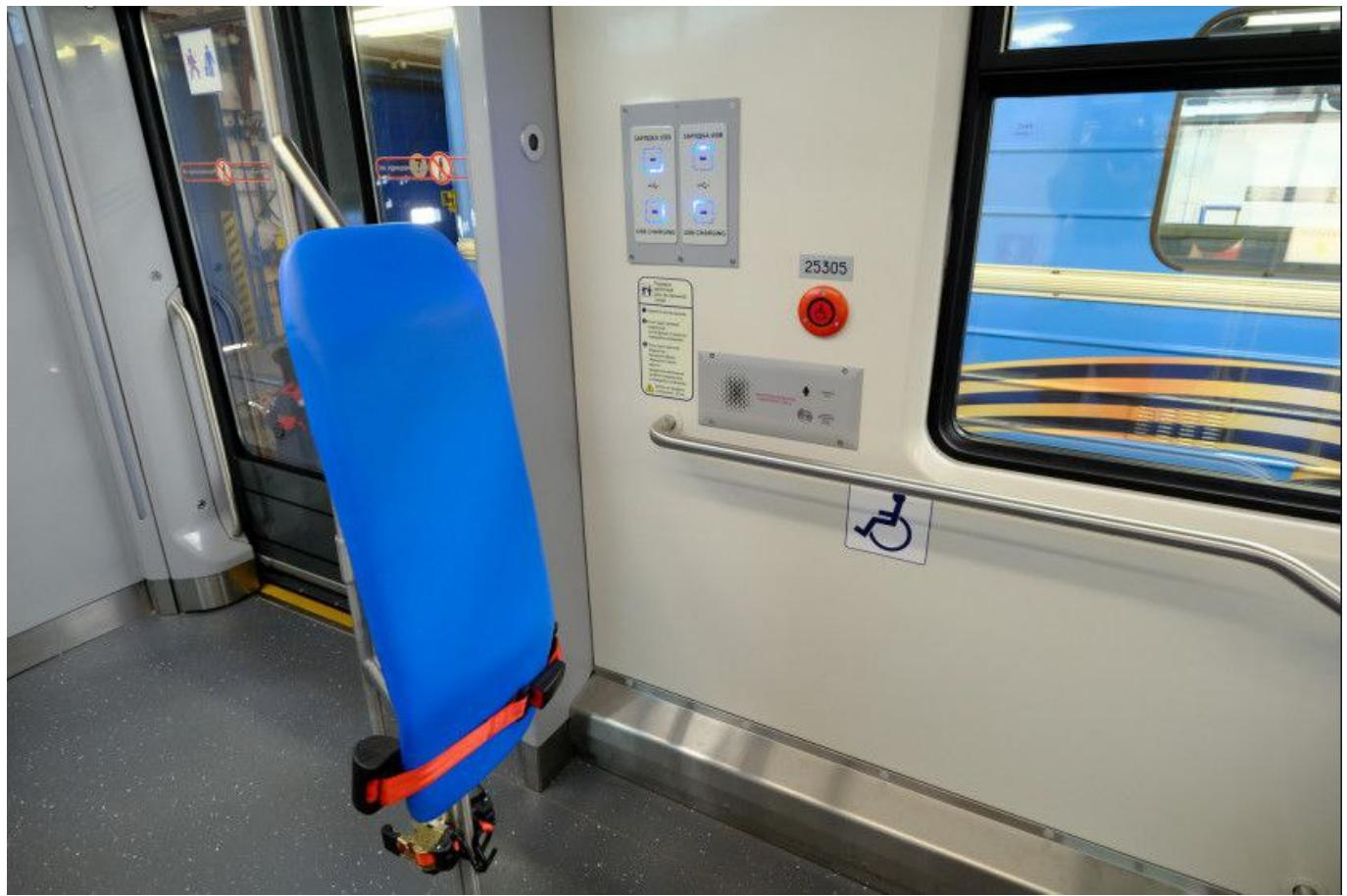
Вагоны имеют широкие дверные проемы – 1400 мм вместо 1208 мм у нынешних. В поезде устойчивое к загрязнениям напольное покрытие с защитой от скольжения; комфортные пассажирские сидения, разработанные с учётом анатомии; защитные экраны между сиденьями и входной зоной; USB-разъёмы для зарядки мобильных гаджетов. Особое внимание безопасности пассажиров – установлена сплит-система с обеззараживанием и очисткой воздуха.
