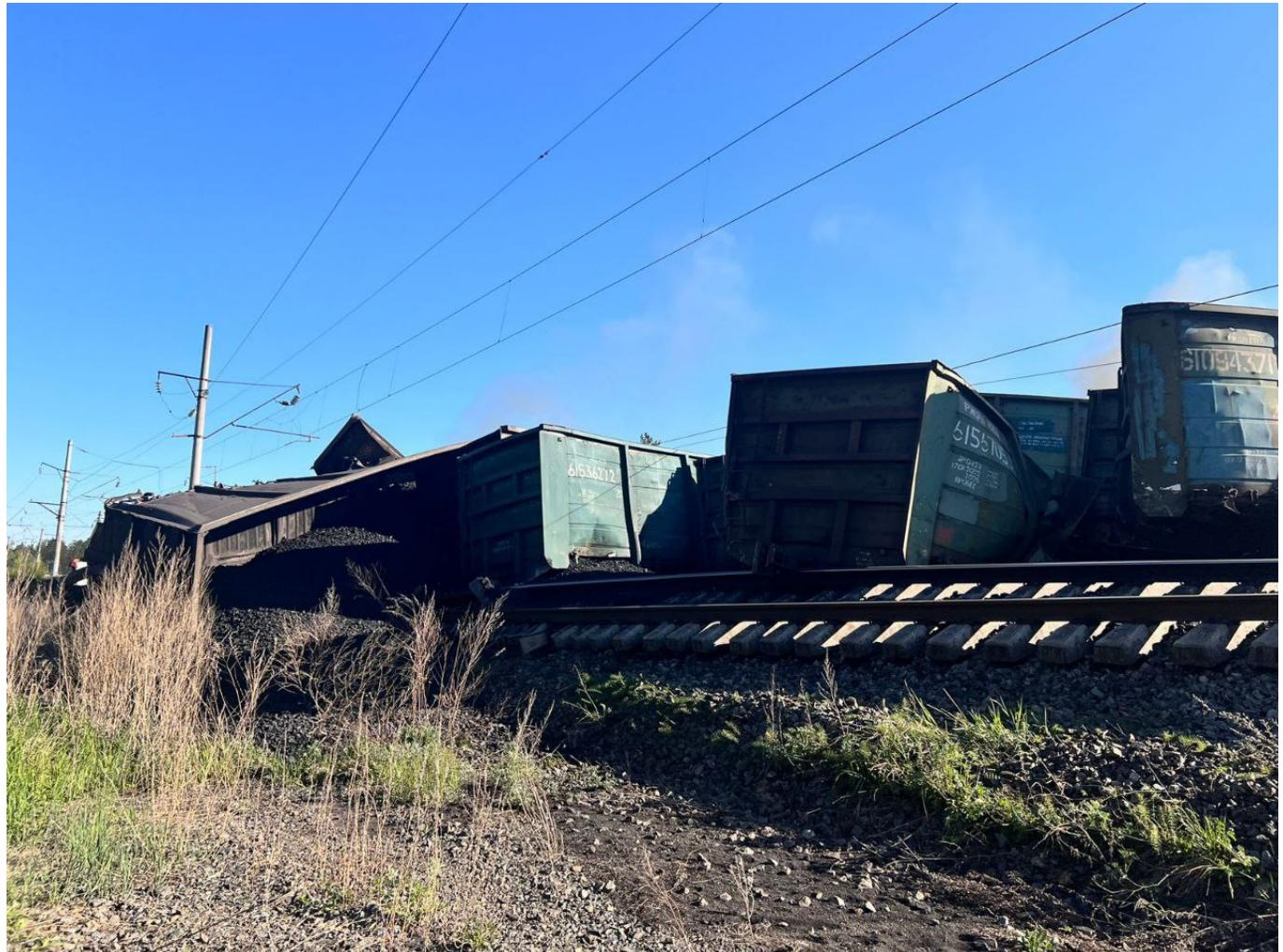
В Амурской области на перегоне Селеткан-Ледяная 7759-го километра Транссибирской железнодорожной магистрали 29 вагонов с углем перекрыли проезд. Причиной стал сход вагонов с рельсов и падение многих на бок.
